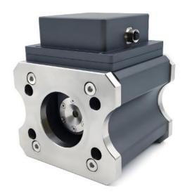
CATUS128 系列一体化油液在线监测传感器,集成了磨损颗粒(铁磁性与非铁磁性)、运动粘度、密度、微量水分、水活性(相对饱和度)、介电常数、含水率和温度等多个检测探头,从而完成对油液的磨损状态与油品理化特性一体式检测任务。该装置小巧、坚固,十分适用于齿轮箱及其他重型工业设备的油品状态监测,是预防性维修、先进智造的可信赖产品。
